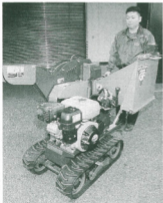
作業音を抑え、軽量化を図った三陽機種の新型の樹木粉砕機
