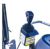
■フィンガータッチのスイッチレバーは、標準タイプ(PC)同様、単独・複合操作をすべてコントロールします。また、ハードで速い作業からミリ単位の操作までアタッチメントの正確かつ微妙な制御が可能です。
