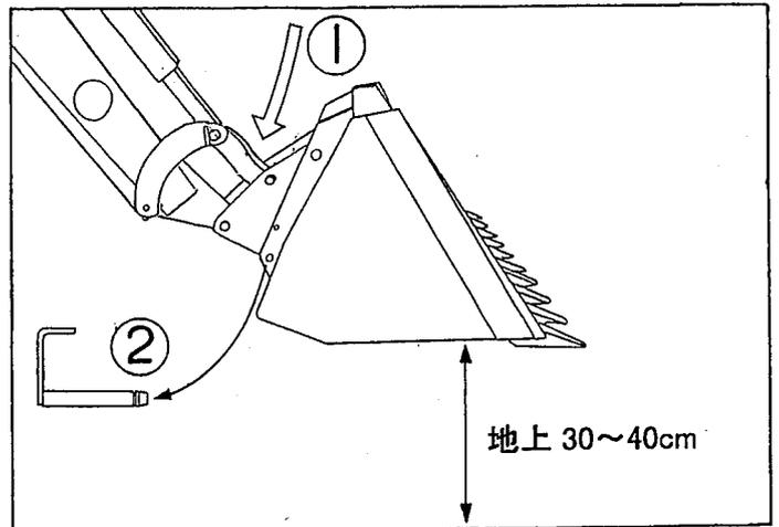
③ 操作レバーを「上昇」にして、アタッチメントをボンネットの高さ位まで上げる。
