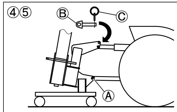
⑤ リフトロッドの長さを調整し、ロアーリンク左右をピンⒶに取付け、リングピンで固定する
