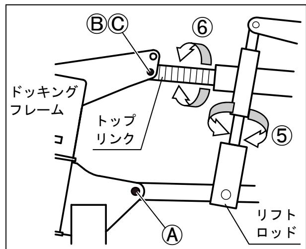
⑥ トップリンクの長さを調整し、ドッキングフレーム上側の取付穴に合わせ、取付ピンⒷを差し込みリングピンⒸ（φ10）で固定する。
