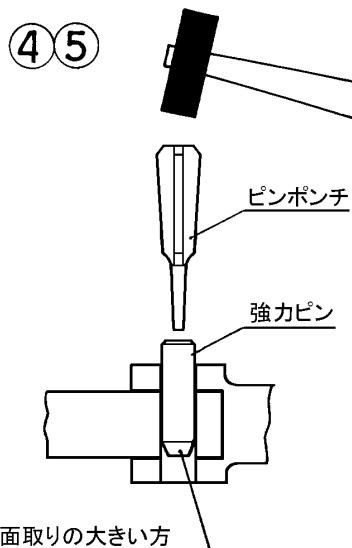
④ ピンポンチ等を使用して、折れた強力ピンを抜き取る。
