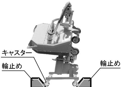
「輪止め」とは、車輪の回転を抑えるもの。上図のように、角材をくさび状に切断したものが一般的です。
