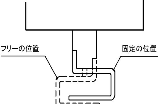
② レバーⒶを引きながら $180^{\circ}$ 回転させる。（時計方向）
