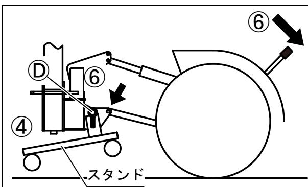
⑥ トラクタの3点リンク昇降レバーを前方に倒し、ロアーリンクを下げる。
