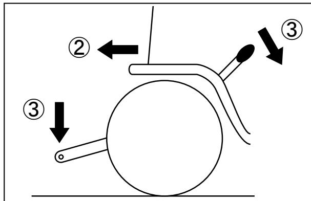
③ トラクタの油圧レバーを操作し、トップフック先端が取付ピン⑧の下側に来るよう調整する
