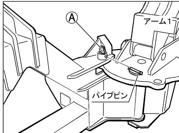
④アームの位置を決め、アームフレームとドッキングフレームの穴合わせをした後セットピンⒶを再び差し込む。
