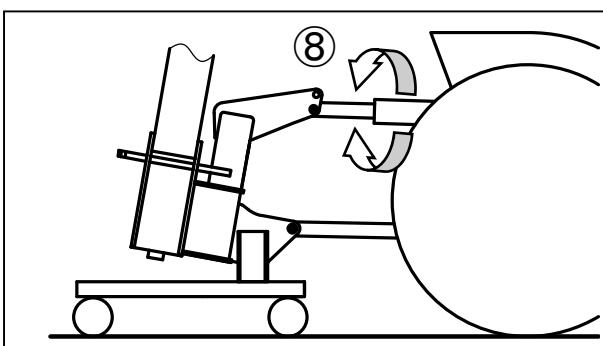
⑨ 取付ピン⑧がゆるんだらピン⑧を抜き取る。
