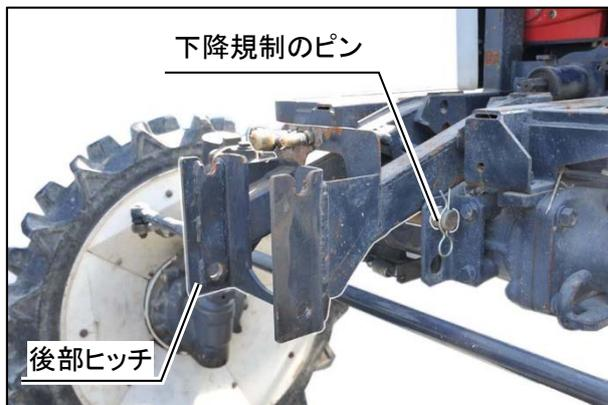
(3) 後部ヒッチヘッドッキングステーを組付け、ピンで固定する。
