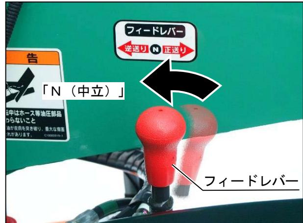
② フィードレバーを「N（中立）」の位置にし、ロータ内に残っている破碎物を排出させる。
