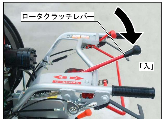
⑥ ロータクラッチレバーをゆっくりと「入」の位置にし、ロータを回転させる。
