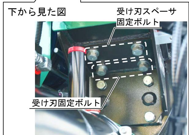
⑥ 受け刃スペーサを挿入し下側からM12ボルト（2本）を仮組付けする。
