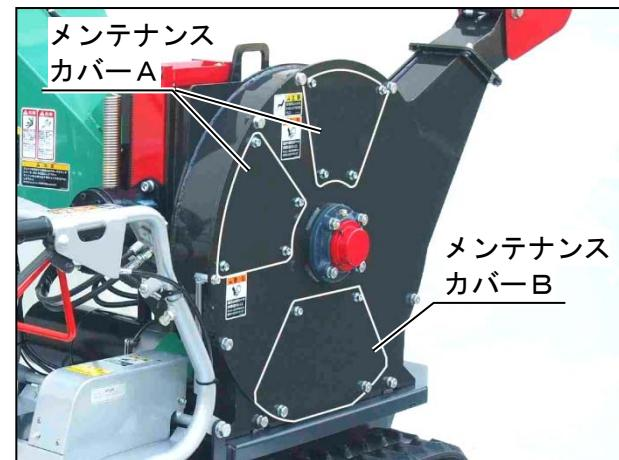
7) つまりの除去が完了したらメンテナンスカバーA・Bを元通り組付ける。
