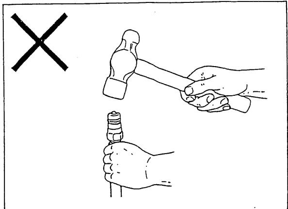
カプラの先端部を傷つけると、油もれや接続不良などを起こし、カプラを破損させる原因となります。残圧のためカプラが結合できない場合は、ホースとカプラのネジ結合部をゆるめて油を少し抜き、再び締め込んでください。（右図）
