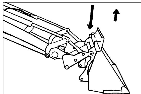
アタッチがはずしたらトラクタを後進させる。
