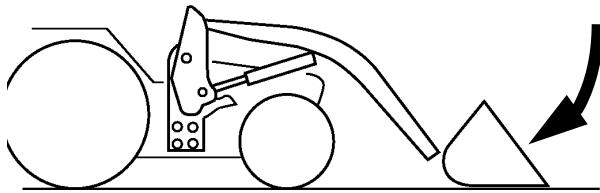
操作レバーを「上昇」にし、先端アタッチメント底面を地上30~40cm浮かせる。
