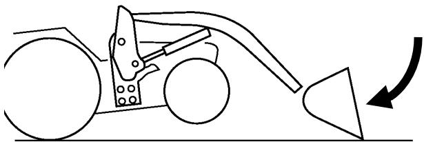
左右のドッキングピンが軽く回れば操作停止する。
