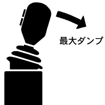
**注意** 増速ダンプ時、ダンプ速度は速くなりますが、普通のダンプに比べ、ダンプ力は減少します。
