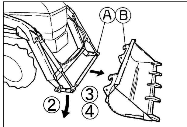
② 1本レバーを「ダンプ」にしてスナップヒッチを前傾させる。
