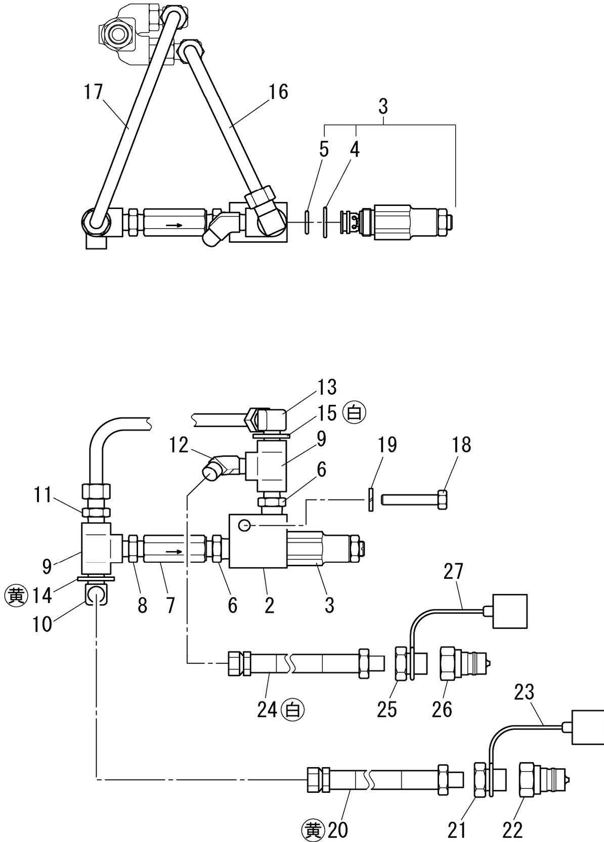
FIG.6 チルトシリンダアツシ詳細
