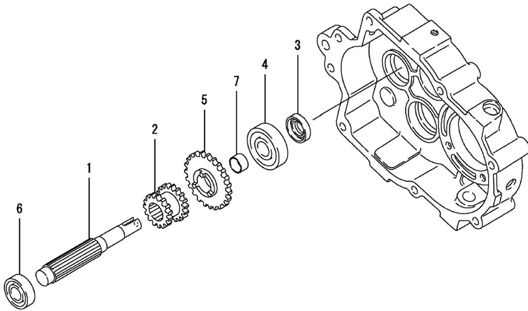
FIG.24 ミッション軸B詳細
