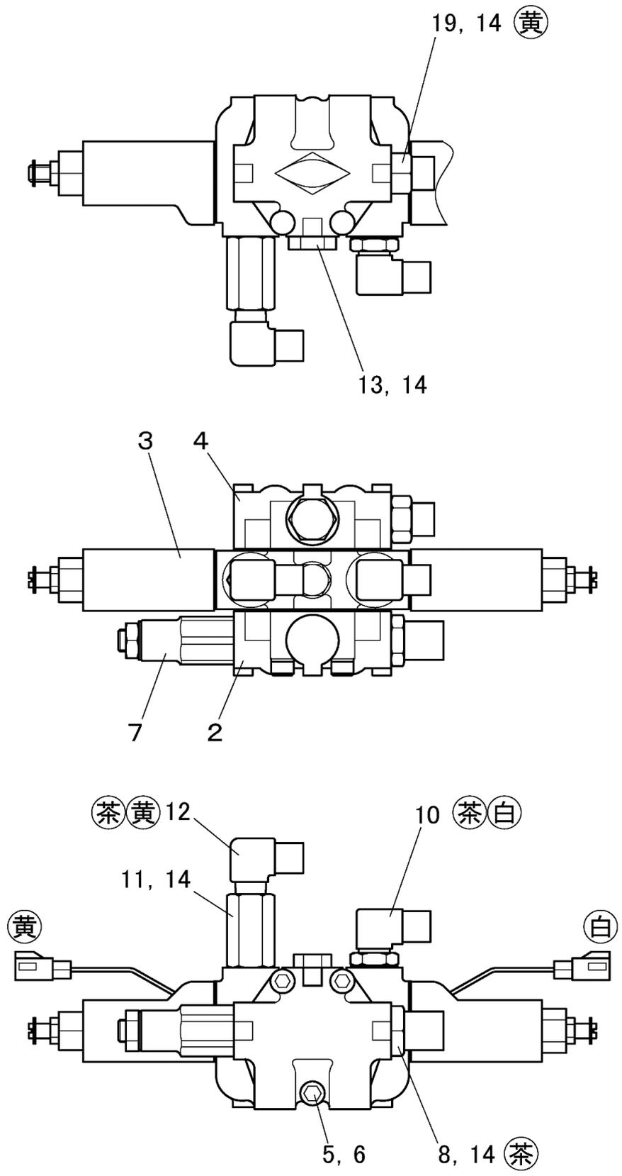
FIG.22 切换弁アツシ詳細
