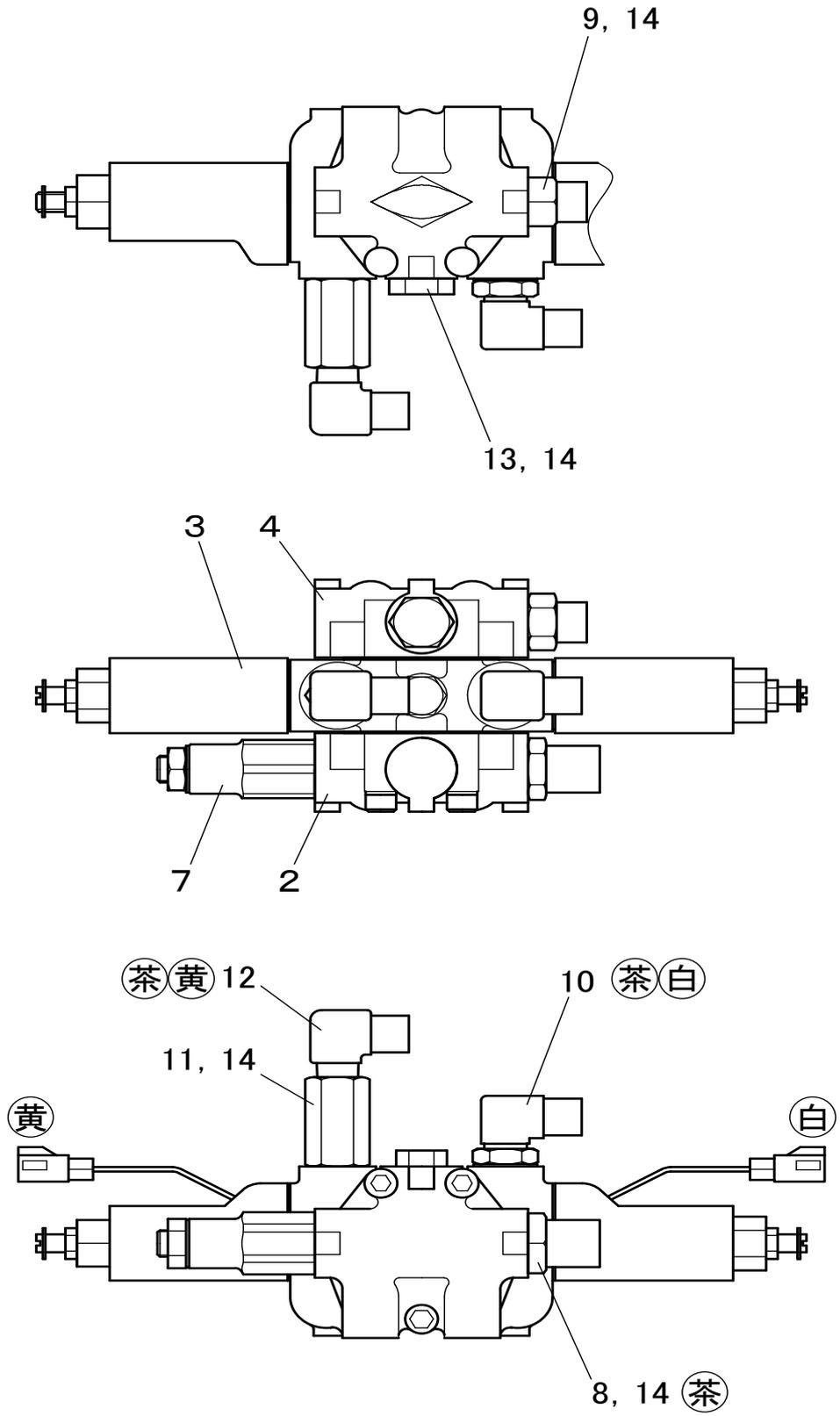
FIG.18 切换弁アツシ詳細
